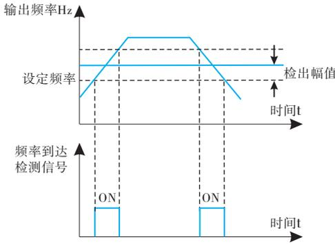
图6-09 频率到达检出幅值示意图
