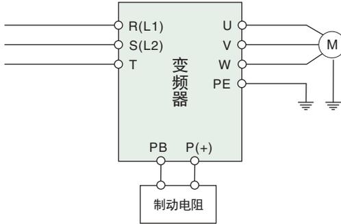
图2-9 变频器与制动组件连线图
