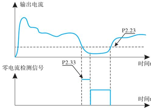
图6-13 零电流检测示意图
