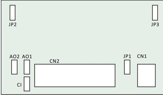
图3-5 控制板端子跳线位置示意图
