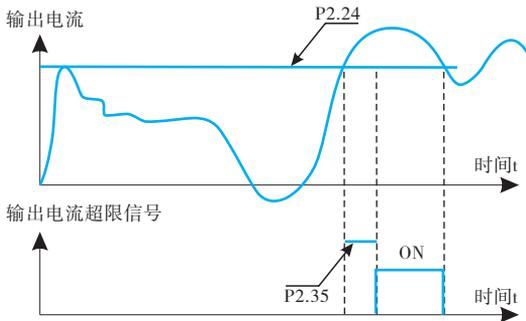
图6-14 输出电流超限检测示意图
