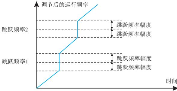
图6-10 加减速过程中跳跃频率有效示意图
