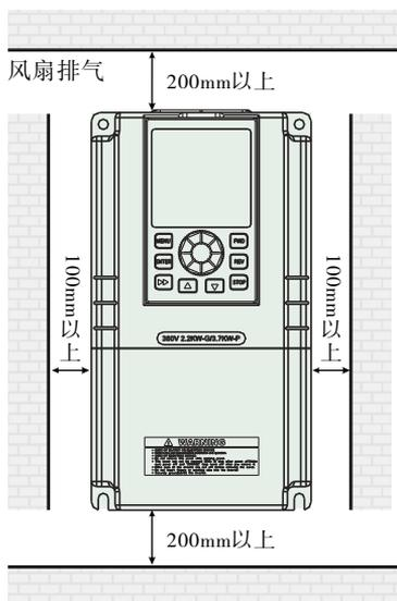
图 3-1 安装间隔距离示意图
