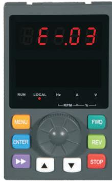
图4-5 故障告警显示状态
