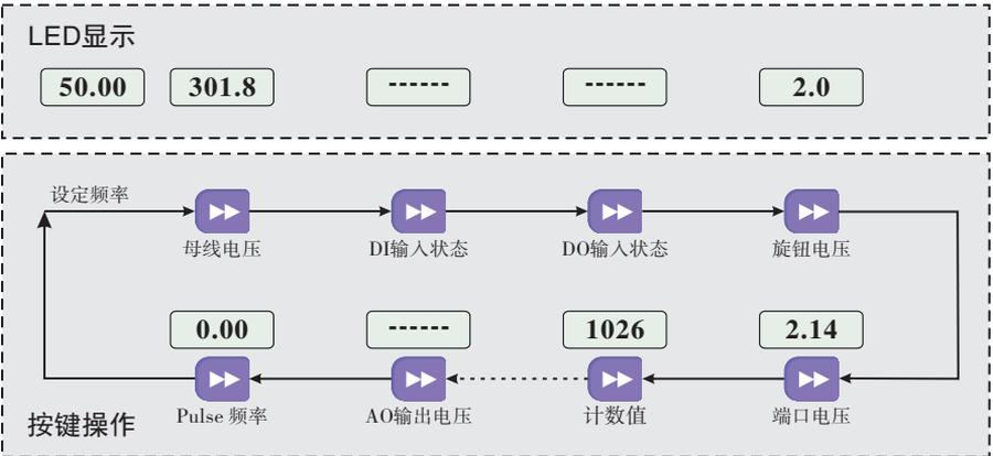
图 4-7 运行状态参数显示操作示例
