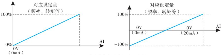
图6-23 模拟给定与设定量的对应关系
