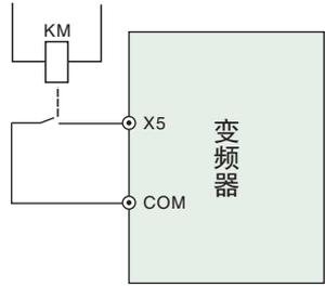
图6-17 外部设备故障输入示意图
