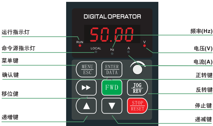
图4-3 操作键盘示意图
